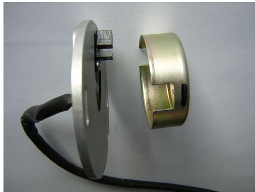
Foto: Zündgeber eines beliebigen V2 Choppers. Die „Fensterbreite“ entspricht dem Schließwinkel.
